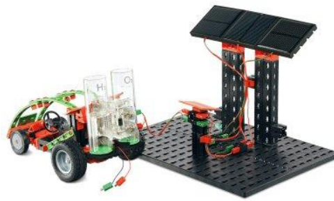
ภาพที่ 3 รถของเล่นขับเคลื่อนด้วยพลังงานไฮโดรเจน 1
