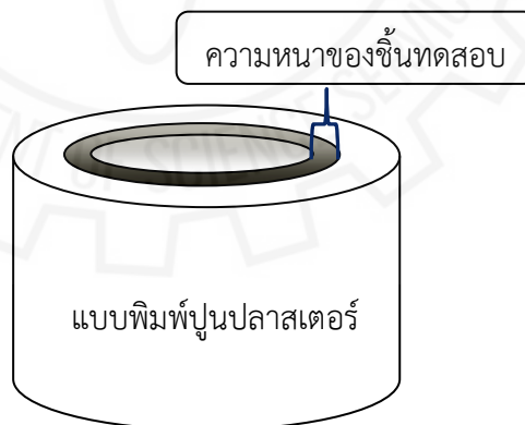
รูปที่ 27 การวัดความหนาของชิ้นทดสอบ
