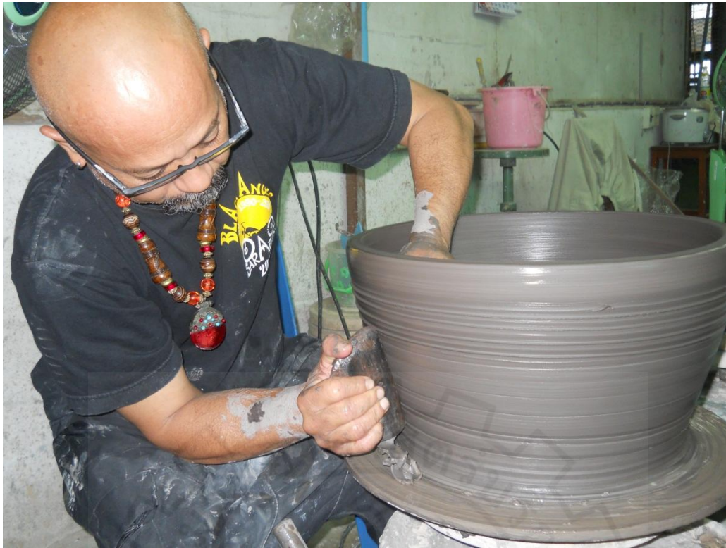
จากนั้นก็ขึ้นรูปโดยการดึงดินให้สูงขึ้นและหนา - บางเท่ากัน
