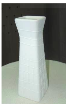
พ่นทับด้วยเคลือบที่มีความหนืดของเคลือบหลอมต่ำกว่าเคลือบปกติ
