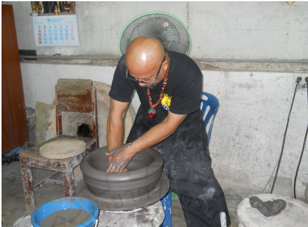
กดดินให้ลึก ขยายให้กว้างตามแบบที่ต้องการ
