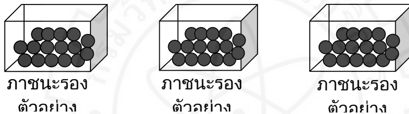
รูปที่ 4 การทดสอบหาความชื้นควรทำอย่างน้อยจำนวน 3 ตัวอย่าง
