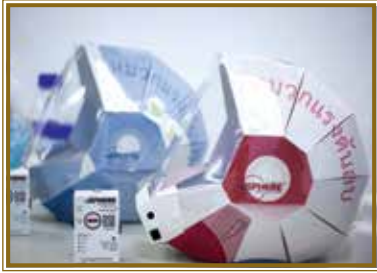
“nSPHERE Pressurized Helmet” หมวกควบคุมแรงดัน (บวกและลบ) พัฒนาโดยศูนย์นาโนเทคโนโลยีแห่งชาติ (NANOTEC) สำนักงานพัฒนาวิทยาศาสตร์ และเทคโนโลยีแห่งชาติ (สวทช.)
