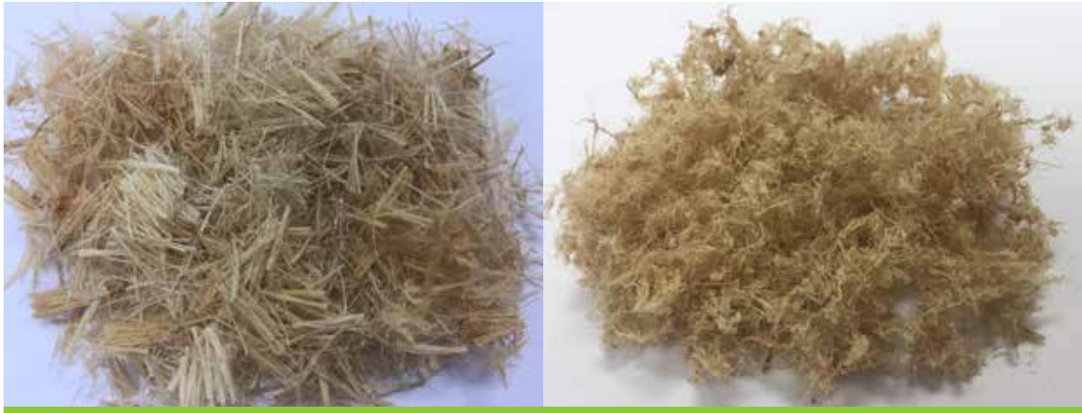
เส้นใยใบสับปรดก่อนและภายหลังการตัดแปรในของเหลวไอออนิกโดยใช้ซัลโฟนิกแอนไฮไดรด์
