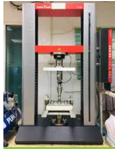
เครื่อง universal testing machine ใช้สำหรับทดสอบรายการ ความต้านแรงอัดความต้านแรงดัด และแรงยึดเกาะ
