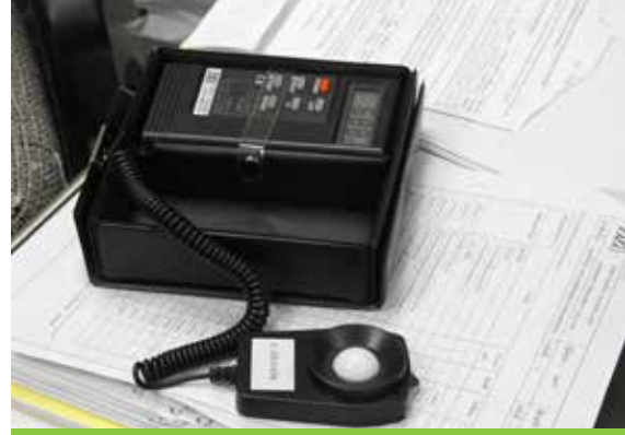
การตรวจวัดความเข้มแสงสว่างบนโต๊ะทำงาน
