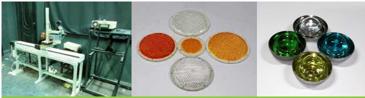
การทดสอบวัสดุเมตริกซ์ทนแสงสำหรับทำเครื่องหมายจราจรบนผิวทาง
