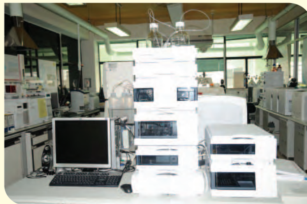
เครื่อง Rapid Resolution HPLC สำหรับการให้บริการทดสอบไฮโดรควิโนนและกรดเรตินอิกในเครื่องสำอาง
