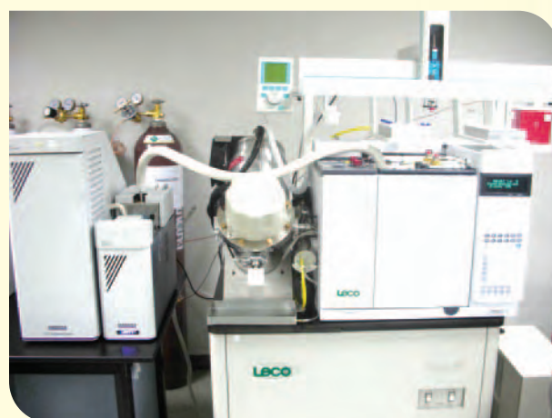
เครื่อง GC/TOFMS สำหรับการให้บริการทดสอบ VOC emission ในผลิตภัณฑ์
