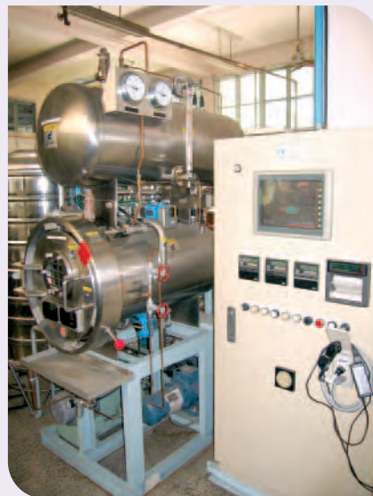
ภาพที่ 2 เครื่องฆ่าเชื้อชนิดฉีดพ่นไอน้ำร้อน (Hot Water Spray Retort) ใช้ฆ่าเชื้อจุลินทรีย์
