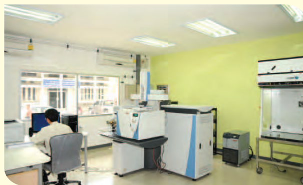
เครื่อง GC/High resolution MS สำหรับการวิเคราะห์สารอินทรีย์ที่ต้องการความแม่นยำและความเที่ยงสูง และสามารถวิเคราะห์สารในระดับปริมาณต่ำๆ
