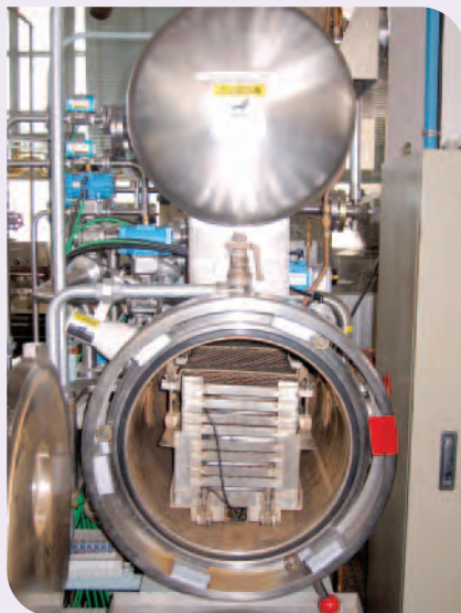
ภาพที่ 2 เครื่องฆ่าเชื้อชนิดฉีดพ่นไอน้ำร้อน (Hot Water Spray Retort) ใช้ฆ่าเชื้อจุลินทรีย์
