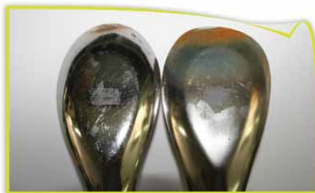
ภาพที่ 1 สภาพตัวอย่างซอสเหล็กกล้าไร้สนิมที่แช่ในสารละลายโซเดียมคลอไรด์ความเข้มข้น 5% นาน 2 วัน
