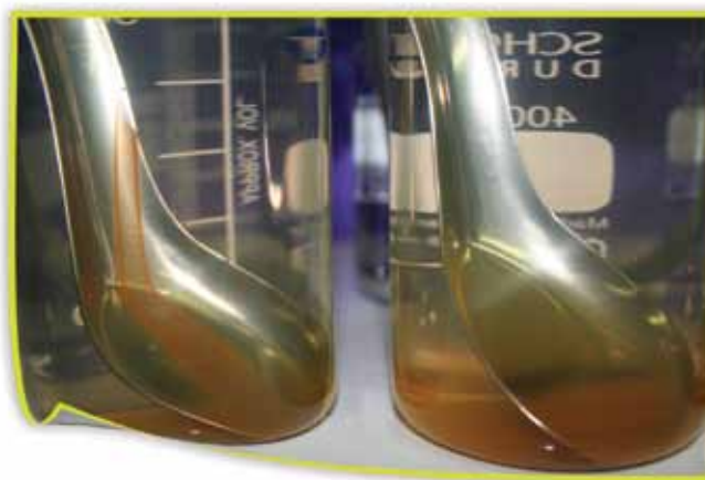
ภาพที่ 2 สภาพตัวอย่างซอสเหล็กกล้าไร้สนิมที่นำออกจากสารละลายโซเดียมคลอไรด์ ความเข้มข้น 5% นาน 2 วัน
