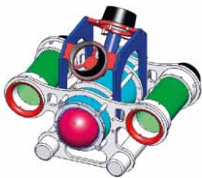
ภาพที่ ๑ : ภาพแสดงมุมมองของยานกลดำน้ำขนาดเล็กด้วยโปรแกรม Computer Aided Design (CAD) และภาพขณะทดสอบการปฏิบัติงานในตู้ทดสอบ
