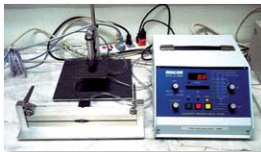
เครื่องทดสอบความแข็งแรงของตะเข็บถุงพลาสติกบรรจุอาหาร
