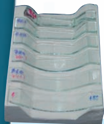
รูป 2 แสดงลักษณะกระจกที่ผ่านการอบที่อุณหภูมิต่างๆ
