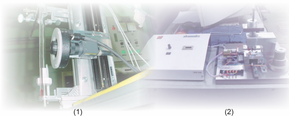
รูปตัวอย่างเครื่องมือและระบบอัตโนมัติในห้องปฏิบัติการที่พัฒนาขึ้น (1) ระบบสอบเทียบเทอร์โมมิเตอร์แบบหลอดแก้ว และ (2) เครื่องทดสอบฉนวนเคลือบสายไฟฟ้าอัตโนมัติ
