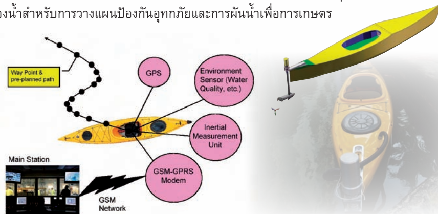
รูปแสดงหลักการทำงานของ ระบบเก็บตัวอย่างน้ำแบบควบคุมระยะไกล
