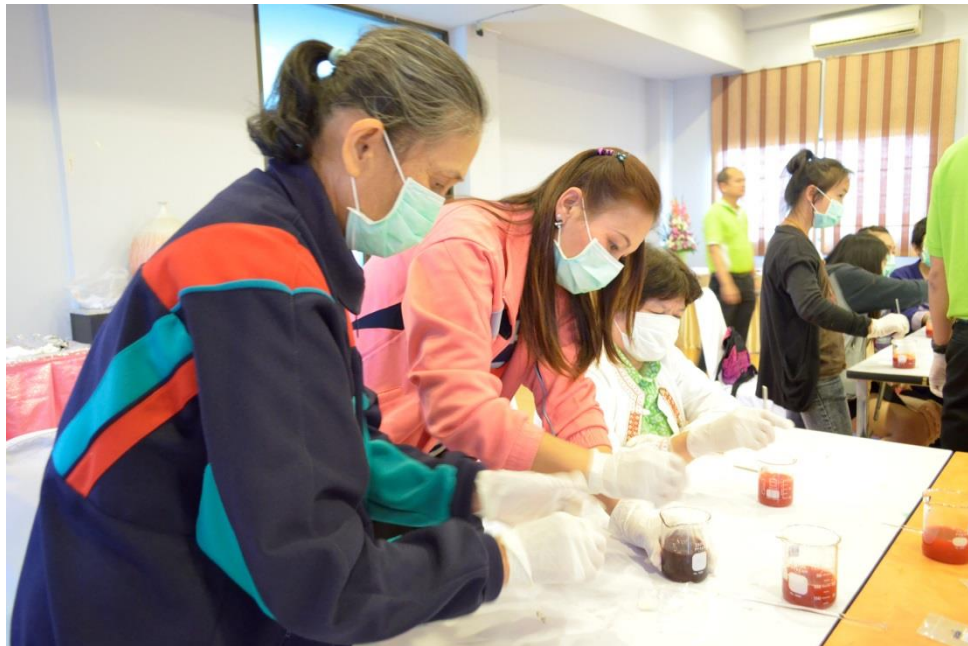
ผู้เข้ารับการฝึกอบรม แบ่งกลุ่มทดลองหาสภาวะที่เหมาะสมในการตกตะกอนสีด้วยสารส้มและคลอรีน
