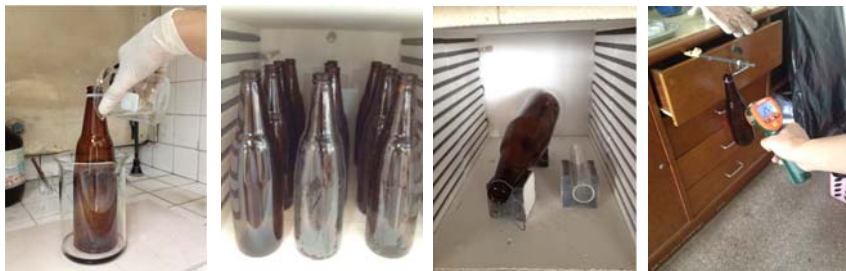
ภาพที่ 2 การทดลองเพิ่มความแข็งแรงให้กับผิวแก้วโดยใช้เทคนิค Heat strengthening, Annealin และ Coatin
