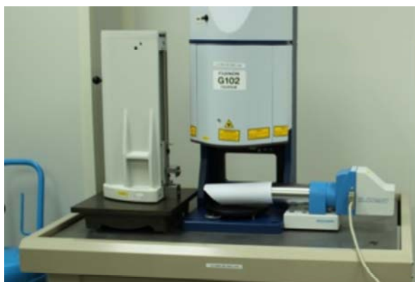
รูป การสอบเทียบฉากมาตรฐานด้วยชุดอโต้คอลลิเมเตอร์
