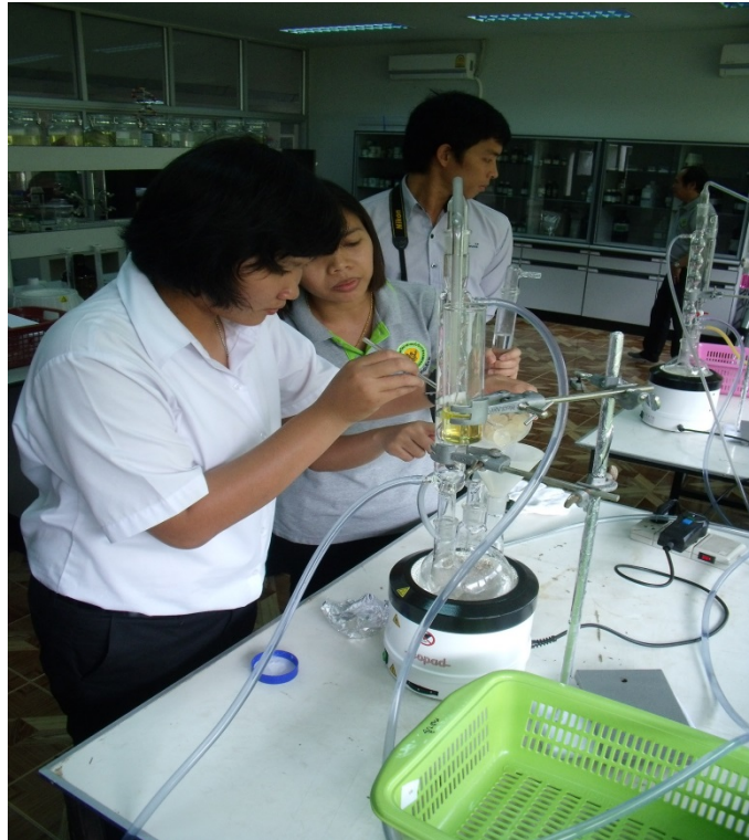
รูปที่ ๓ การฝึกปฏิบัติการทดสอบซัลเฟอร์ไดออกไซด์ในลำไยสด
