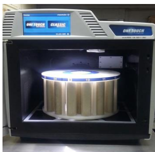
เตรียมตัวอย่างด้วยเครื่อง Microwave digestion
