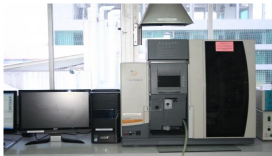
ทดสอบโลหะเป็นพิษด้วยเครื่อง Atomic Absorption Spectrophotometer (AAS)
