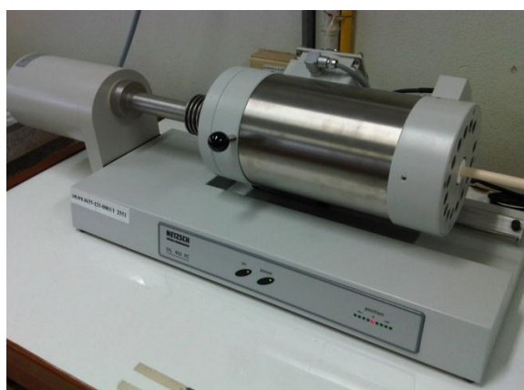
เครื่องวัดสัมประสิทธิ์การขยายตัวของแก้วเมื่อได้รับความร้อน (Dilatometer)
