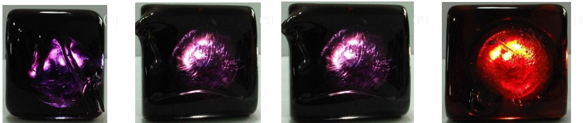
รูปที่ 4.8 แสดงชิ้นงานแก้วที่ปรับปรุงสูตรโดยการเติมสารเติมแต่ง (ก) \text{CaF}_2 0.5wt%, \text{ZnO} 0.8wt%, \text{SnO}_2 0.2wt% (ข) \text{CaF}_2 1wt%, \text{ZnO} 0.6wt%, \text{SnO}_2 0.2wt% (ค) \text{CaF}_2 0.1wt%, \text{ZnO} 0.8wt%, \text{SnO}_2 0.2wt% (ง) \text{Sb}_2\text{O}_3 0.5wt%, \text{ZnO} 1.0wt%, \text{SnO}_2 0.9wt%
