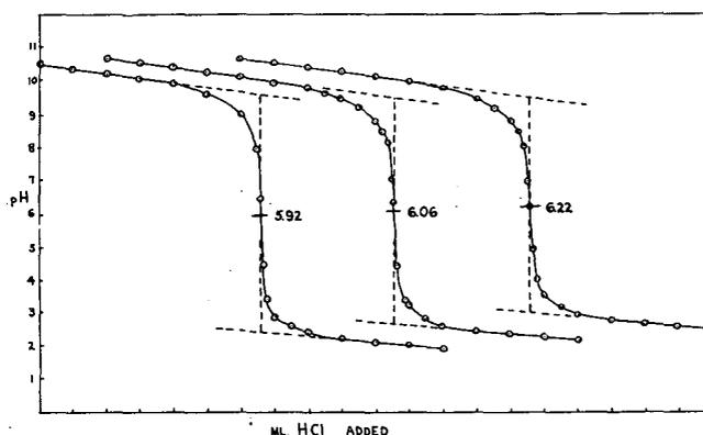
Figure 1. Potentiometric Titration Curves
