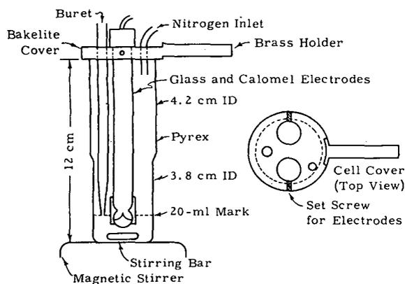
Figure 2. Reduced-Scale Titration Cell
