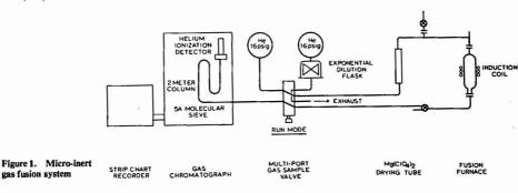
STRECORDER CHROMATOGRAPH GAS SAMPLE DRYING TUBE FURNACE
