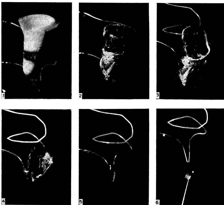
Fig. 1. Veraschung eines Staubsammelfilters und Aufschluss des Staubes in der Schmelzperle.
