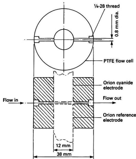
Fig. 2. Detector cell
