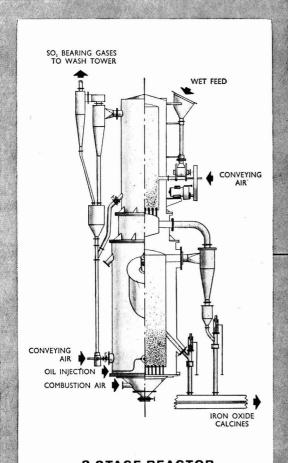
2 STAGE REACTOR FOR FERROUS SULPHATE DECOMPOSITION
