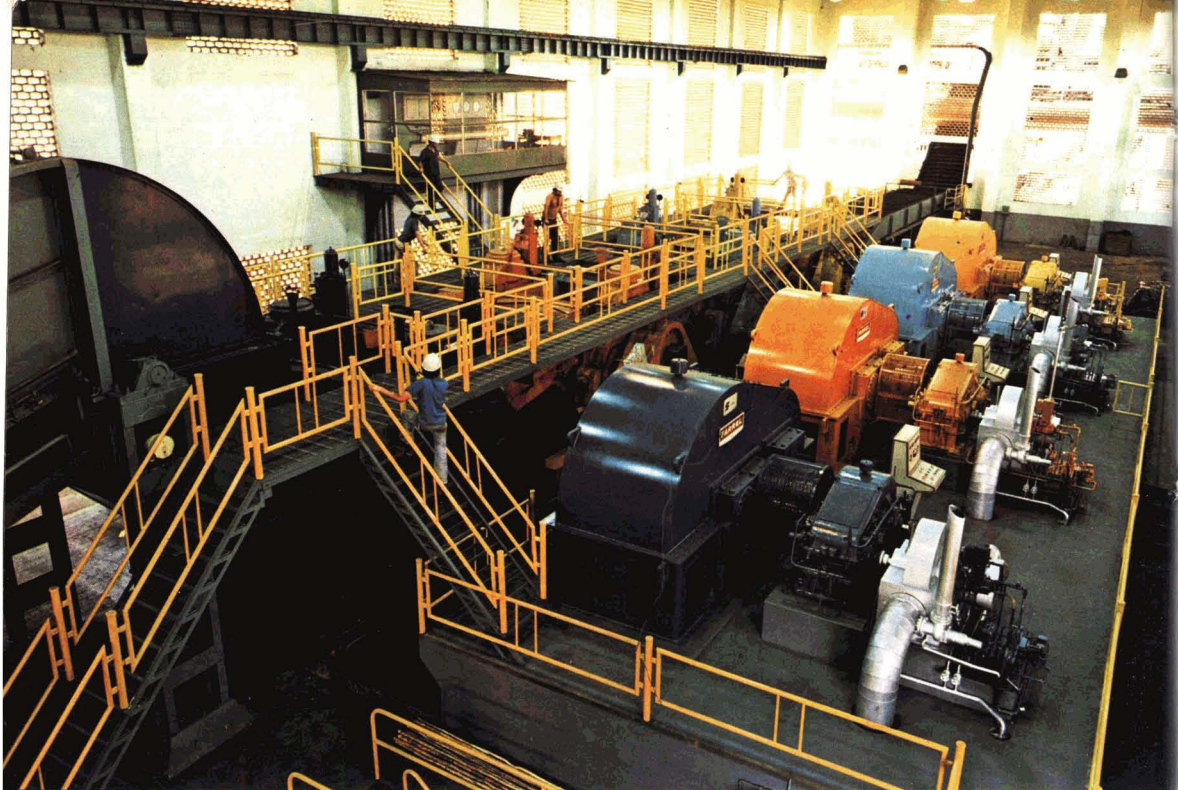
Trapiches Zanini-Farrel 42" x 84" - Usina São Martinho - trapiches con 4 molinos - 8 000 TCD - 12% FIBRA
