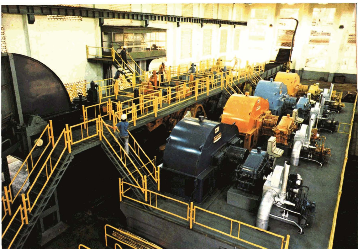
Trapiches Zanini-Farrel 42" x 84" - Usina São Martinho - trapiches con 4 molinos - 8.000 TCD - 12% FIBRA
