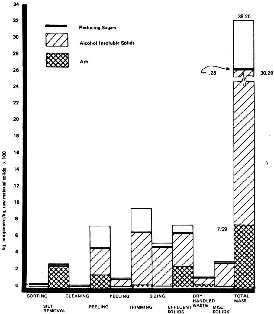
FIG. 3. COMPOSITION OF WASTE STREAMS FROM UNIT OPERATIONS FOR POTATO PROCESSING
