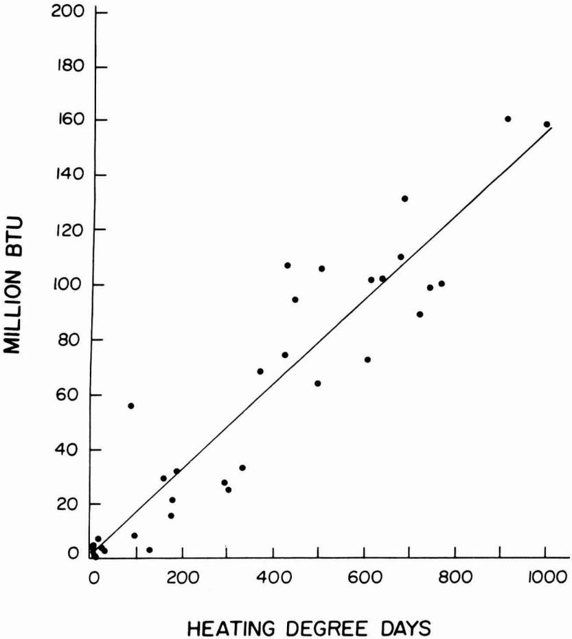
FIG. 4. NATURAL GAS CONSUMPTION BY THE FISH PLANT VERSUS HEATING DEGREE-DAYS
