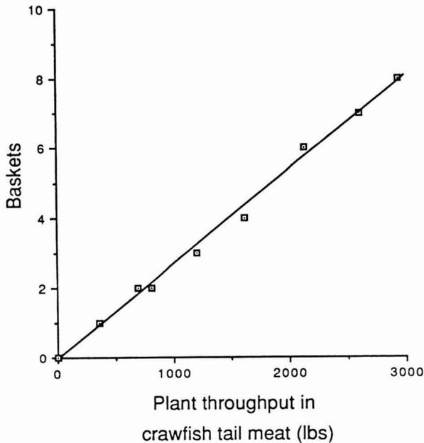
FIG. 3. BASKETS (200-lb CAPACITY) REQUIRED FOR DIFFERENT LEVELS OF OPERATION
