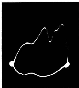
Fig. 3. Oszillographische Kurve von Osmium in Chlorwasserstoffsäure: 1 M HCl und 2 \cdot 10^{-5} M Os; Tropfelektrode; Polaroskop.
