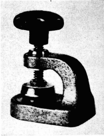
Abb. 23. Einspannelektrode zur Leitfähigkeitsmessung von Platten. (K. P. Mundinger, Renningen/Württ.)
