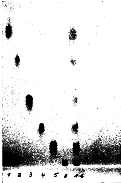
Fig. 1. Dünnschichtchromatogramm an Polyamid im System Dimethylformamid-Benzol (3:97) von Phenylosazonen von (1) Glycolaldehyd, (2) Glycerinaldehyd, (3) D-Erythrose, (4) D-Xylose, (5) D-Glucose, (6) D-Lactose. Es wurden 2 cm vom unteren Rand der Platte 1%ige Lösungen in Pyridin in Abständen von jeweils 1 cm aufgesetzt. Laufstrecke: 14 cm.
