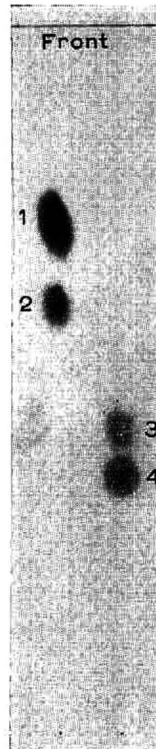
Fig. 4. Absteigend auf mit Paraformaldehyd imprägniertem Papier angefertigtes Chromatogramm zur Trennung von Farnesol(1)-Geraniol(2) und Anisaldehyd(3)-Zimtaldehyd(4). Fließmittel: 1; Laufzeit: 4 Std. (23°); Anfärbung: Osmiumtetroxid und 2,4-Dinitrophenylhydrazin nacheinander.
