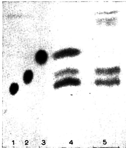
Fig. 1. Papierchromatogramm eines ägyptischen Geraniumöles (Trennung von Geraniol, Citronellol und Linalool). Methode: aufsteigend mit Fließmittel 5 auf mit Paraformaldehyd imprägniertem Papier; Laufzeit: 90 Min.; Anfärbung: Osmiumtetroxid. 1 = Geraniol; 2 = Citronellol; 3 = Linalool; 4 = Gemisch aus Geraniol, Citronellol und Linalool; 5 = ägyptisches Geraniumöl.
