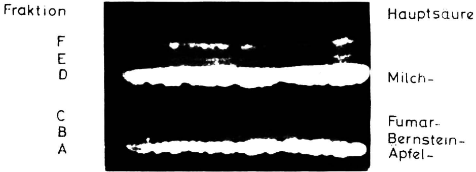
Fig. 5. Dünnschichtchromatographische Auftrennung der aus Apfelsaft extrahierbaren Säuren in Fraktionen. Schicht: Kieselgur-Kieselgel (1:1). Laufmittel: Benzol-Äthanol-NH 4 OH (10:20:5).
