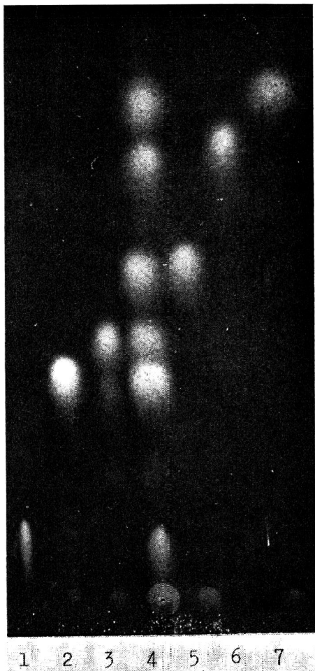
Fig. 1. Dünnschichtchromatogramm einiger Isoflavone und Cumöstrol im UV-Licht aufgenommen. 1 = Cumöstrol; 2 = Daidzein; 3 = Genistein; 4 = 1-3 und 5-7; 5 = Pratensein; 6 = Formononetin; 7 = Biochanin A. Laufzeit, 90 min; Sprühmittel, Reagens 6 und 9, siehe Tabelle II. Weitere Einzelheiten im Text.
