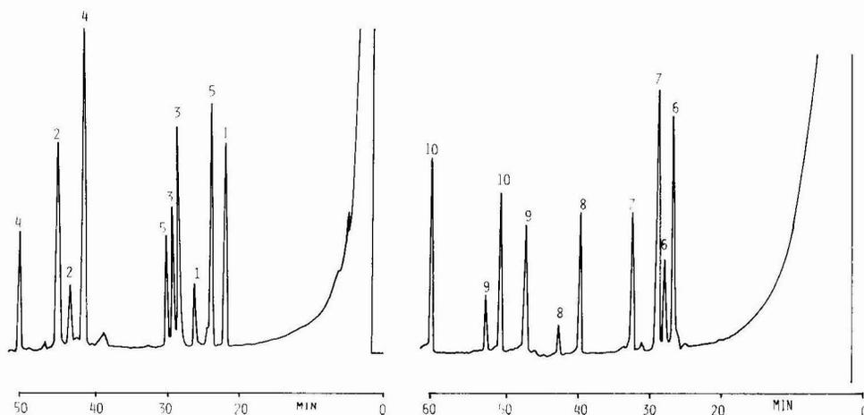
Fig. 4. Gas-Flüssigkeits-Chromatographische Trennung von TMS-Lyxose (1), TMS-Allose (2), TMS-6-Desoxyallose (3), TMS-Mannose (4) und TMS-Rhamnose (5) an einer OV-101 Glaskapillarsäule; Trennbedingungen wie in Fig. 2.
