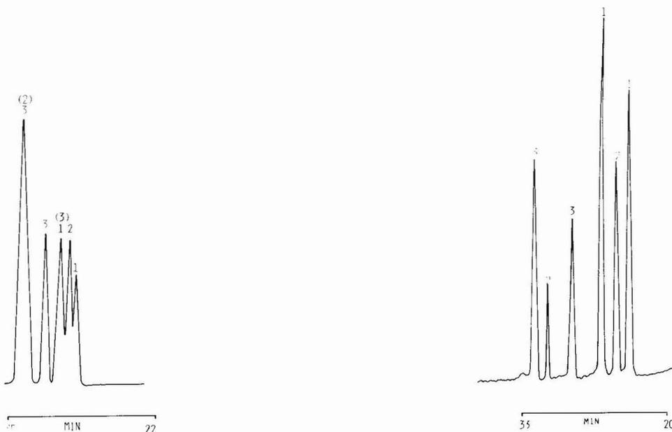
Fig. 1. Gas-Flüssigkeits-Chromatographische Trennung von TMS-Arabinose (1), TMS-Rhamnose (2) und TMS-Fucose (3) an gepackter Säule; Säule: Pyrex 10 ft.  $\times$   $\frac{1}{4}$  in O.D.  $\times$  2 mm I.D.; Trennfilm 1.6% OV-101 auf Chromosorb G (100–120 mesh); Trägergas ( $N_2$ ): 20 ml/min; Temperatur Injektor 230 C, Detektor 240 C; Programm 100–240 C (2°/min).
