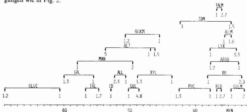
Fig. 6. Retentionszeiten der TMS-Monosaccharide an einer OV-17 Glaskapillarsäule und Peakflächenverhältnisse der anomeren Formen nach Behandlung mit Säure. Glaskapillare 24 m  $\times$  0.28 mm I.D., Trennfilm OV-17; Trägergas ( $N_2$ ) 0.6 ml/min, Split 1:30; Temperatur Injektor/Detektor 225°C; Ofen, Programm 150–200°C, 1°C/min; Initialzeit 20 min. Abkürzungen vgl. Fig. 3.
