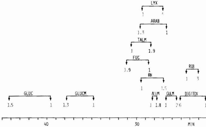
Fig. 2. Retentionszeiten der TMS-Monosaccharide nach saurer Hydrolyse sowie Peakflächenverhältnisse der anomeren Formen an OV-17; Säule: Pyrex 6 ft.  $\times$  1/4 in. O.D.  $\times$  2 mm I.D., 6% OV-17 auf Chromosorb W (100–120 mesh); Trägergas: N<sub>2</sub>, 13.5 ml/min; Temperatur: Injektor/Detektor 225°C Ofen, Programm 100–200°C (2°/min). Abkürzungen vergleiche Fig. 1.
