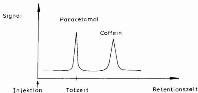
Fig. 1. Chromatogramm-Schema.
