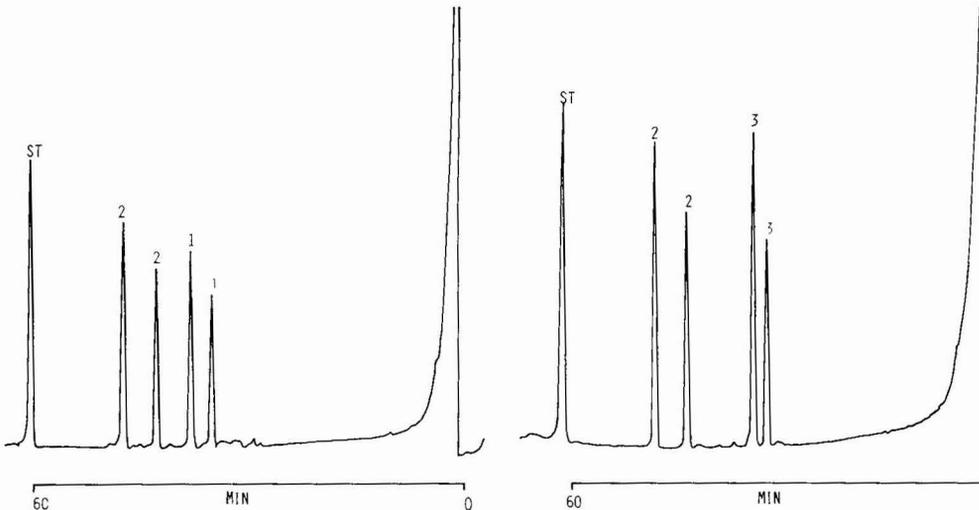
Fig. 3. Gas-Flüssigkeits-Chromatogramm der TMS-Monosaccharide aus Glucoallid (Bipindogenin-6-desoxyglucosido-glucosid) nach saurer Hydrolyse, Trennbedingungen vgl. Fig. 1. 1 = 6-Desoxyglucose, 2 = Glucose, ST = Phenyl- $\beta$ -D-glucopyranosid.
