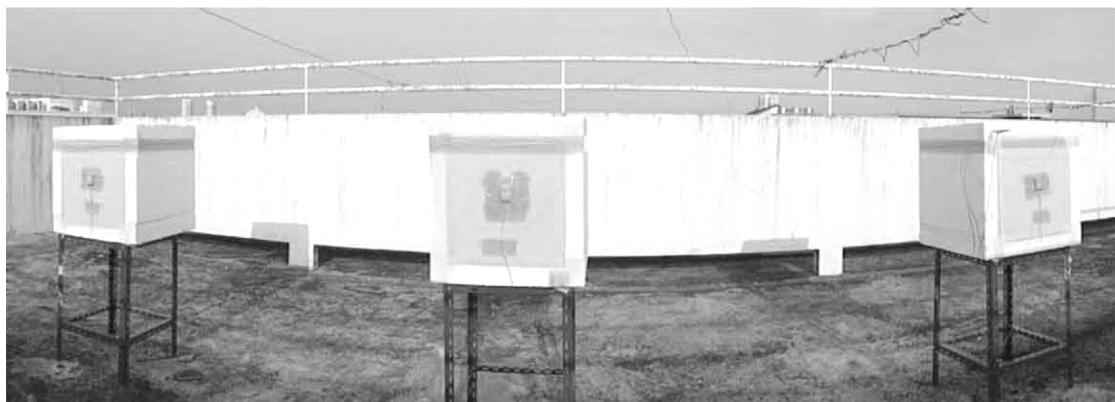
ภาพที่ 4 แสดงการทดสอบความสามารถในการป้องกันความร้อนด้วยกล่องทดลอง
