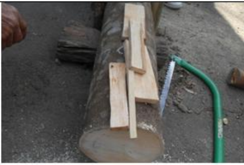
ไม้ยางพารา หักเป็นท่อนผ่า ความยาว 15 ซม. กว้าง 1 ซม.
