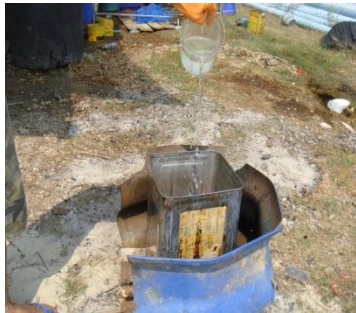
h. ใส่โซเดียมไฮดรอกไซด์ลงบน กากสับปะรดและต้มให้ความร้อน 3 ชั่วโมง
