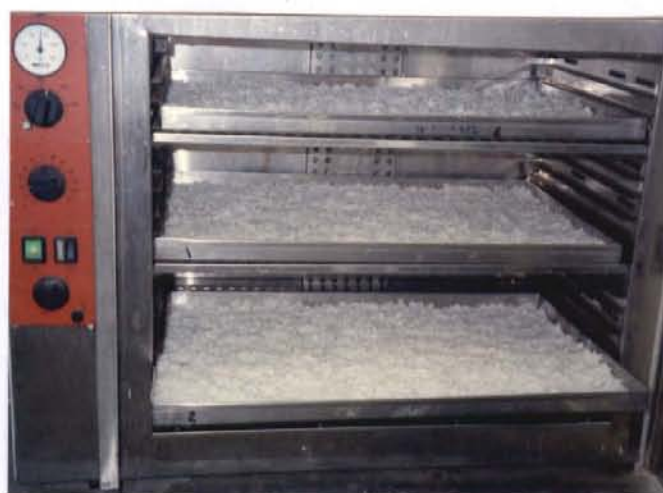
ภาพที่ 3 ตู้อบลมร้อน (cabinet dryer) ใช้ในการอบแห้งข้าวกล้องสำเร็จรูป
