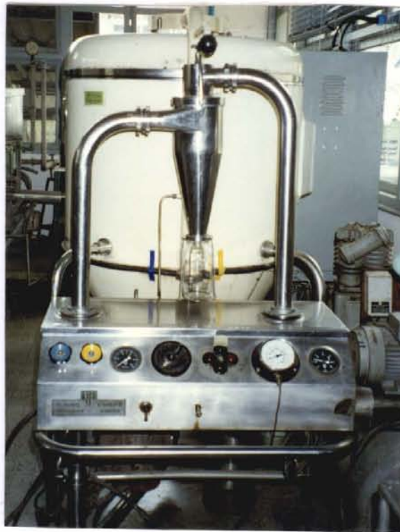
ภาพที่ 5 เครื่องทำอาหารแห้งแบบพ่นฝอย
