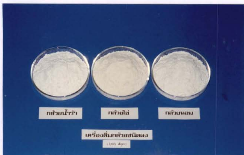
ภาพที่ 6 เครื่องตีกล้วยชนิดผง ผลิตจากกล้วยน้ำว้า กล้วยไข่ และกล้วยหอม โดยเครื่องทำอาหารแห้งแบบพ่นฝอย
