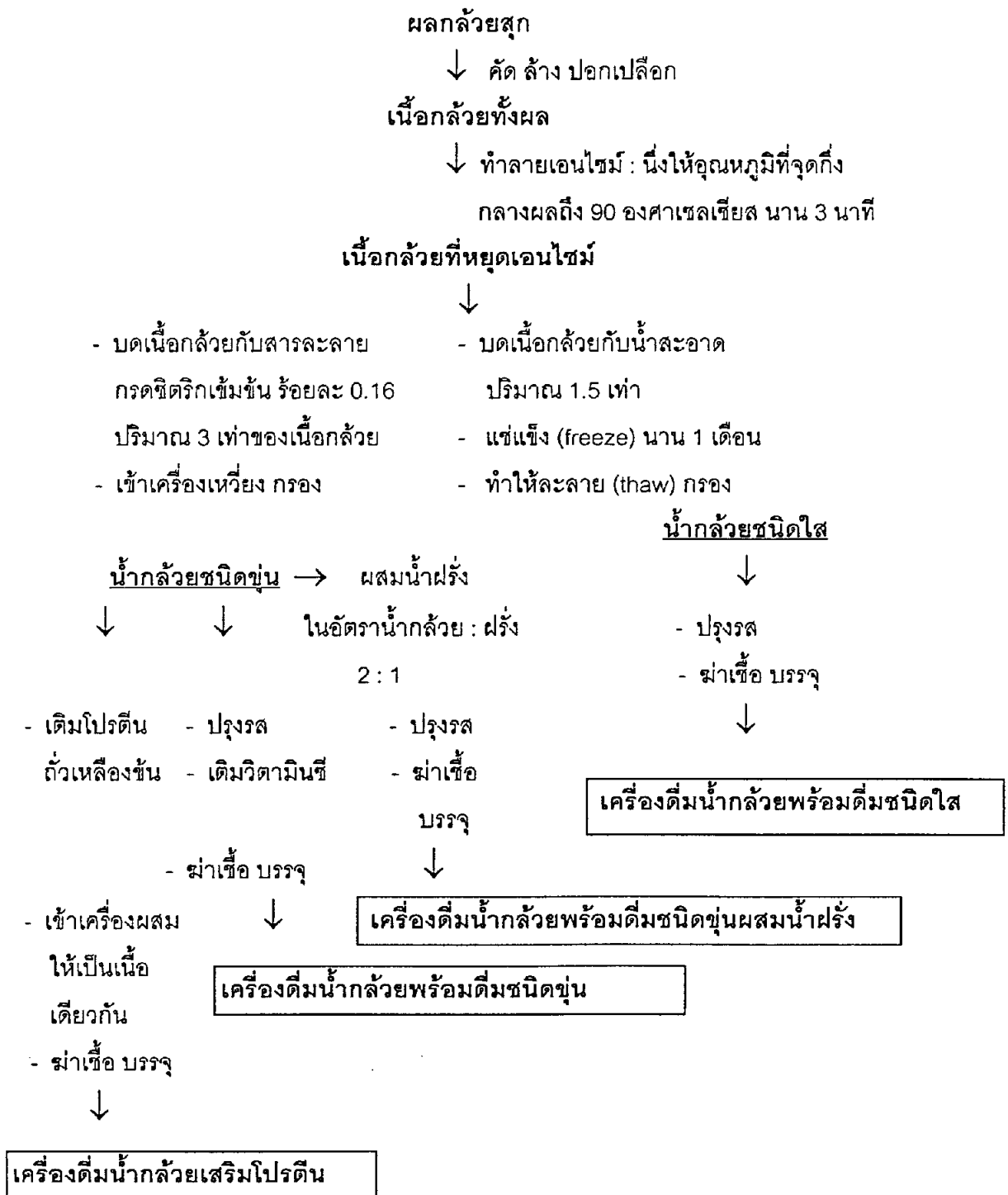
แผนผังที่ 1 แสดงกรรมวิธีผลิตเครื่องตม่น้ำกล้วยพร้อมตม่นิตชุนและนิตไส
