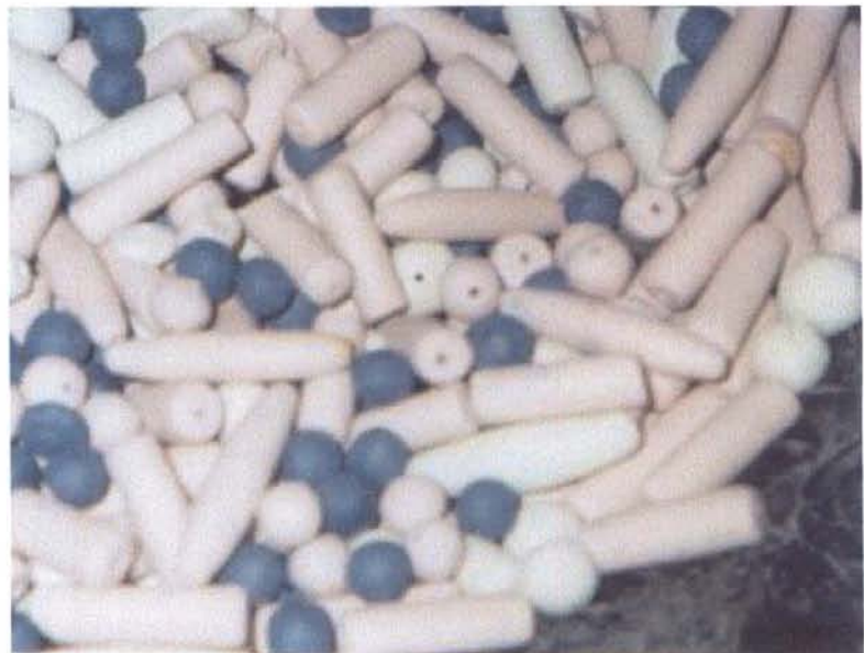
ภาพที่ 5 ใช้เนื้อดินผสมสีในการผลิต
