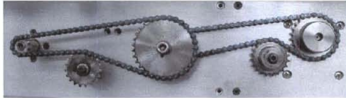
รูปที่ 2 แสดงชุดเฟืองโซ่ของเครื่องทดสอบแรงอัดซ้ำคงที่ของยางพองน้ำลาเทกซ์
